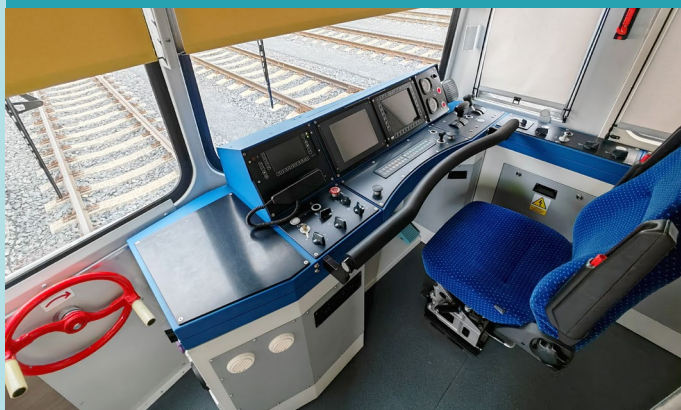
← Stanoviště strojvedoucího, řídicí pult
